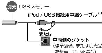
\* 1 グローブボックス等から出ている付属の iPod / USB接続用中継ケーブルを引き出して接続してください。(ケーブルの設置場所は、車種により異なります。)
