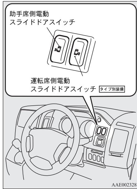
電動スライドドアが全閉位置のときに、電動スライドドアスイッチを約1秒以上押すと警報ブザーが1回鳴り、全閉位置まで電動スライドドアが開きます。
