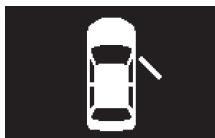
いずれかのドアおよびテールゲートが完全に閉められていないときに開いているドアまたはテールゲートを表示します。
