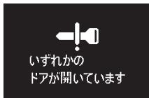
エンジンスイッチが LOCK (PUSH OFF) の位置にあるとき、いずれかのドアまたはテールゲートを完全に閉めずにドアスイッチおよびテールゲートの LOCK スイッチを押して施錠しようとすると、警告表示と約 3 秒間のブザーで警告し、ドアおよびテールゲートの施錠ができません。
