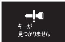
駐車中、かつエンジンスイッチが LOCK (PUSH OFF) 以外の位置にあるとき、いずれかのドアを開けてキーレスオペレーションキーを車内から持ち出した後ドアを閉めると、警告表示と 4 回鳴るブザーで警告します。
