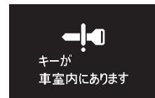
エンジンスイッチが LOCK (PUSH OFF) の位置にあるとき、車内にキーレスオペレーションキーを置いたまますべてのドアおよびテールゲートを閉め、ドアスイッチおよびテールゲートの LOCK スイッチを押して施錠しようとすると、警告表示と約 3 秒間のブザーで警告し、ドアおよびテールゲートの施錠ができません。
