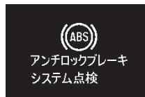
システムに異常があると警告灯が点灯します。また、マルチインフォメーションディスプレイ内のインフォメーション画面にも警告表示が表示されます。
