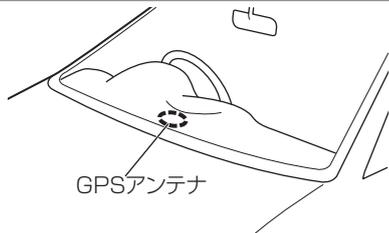
自車の位置は、GPS 衛星および準天頂衛星からの微弱な電波を「GPS アンテナ」で受信して測位しています。
