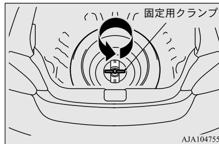
固定用クランプを反時計回りに回して外し、タイヤを取り出します。
