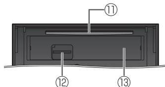
地図SDカード挿入口カバーを取り外した状態
