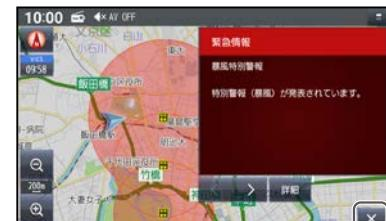
地図画面で[緊急情報受信中]をタッチすると、緊急情報画面(詳細情報)が表示されます。
