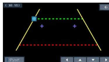
6. [+]をタッチして、[◀]/[▶]で車幅目安線との間隔がおよそ1:2:1になるよう調整する
