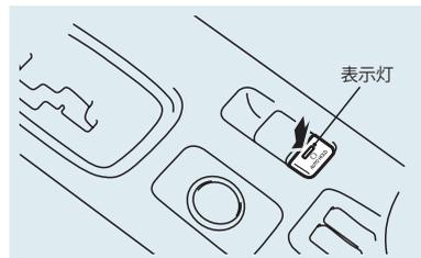
つぎの条件がそろったときにスイッチを押すと、システムがスタンバイ状態に切り換わり、スイッチ内の表示灯が点灯します。
