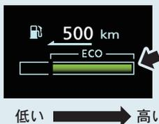
走行状態に応じて、燃費により運転度合いを表示します。走行速度に合ったアクセルペダルの操作でECO運転をしているとECOドライブアシストが左図のように変化します。
