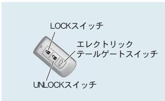
LOCK スイッチを押すとすべてのドアおよびテールゲートが施錠し、UNLOCK スイッチを押すとすべてのドアおよびテールゲートが解錠します。UNLOCK スイッチを押して解錠しても約 30 秒以内にドアまたはテールゲートを開けなければ自動的に施錠されます。また、エレクトリックテールゲート付き車は、エレクトリックテールゲートスイッチを押すと、自動でテールゲートを開けることができます。
