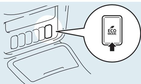
ECOモードは、エンジン、エアコン、S-AWC (S-AWC付き車) を自動制御することで、燃費向上に配慮したエコドライブをサポートするシステムです。エンジンスイッチの電源モードがONのときに、ECOモードスイッチを押すとECOモードが作動します。もう一度スイッチを押すとECOモードが停止します。ECOモード作動中、メーター内にECOモード表示(表示灯)が表示されます。
