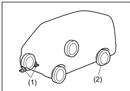
4 工具、ジャッキ、応急用スペアタイヤを取り出します。同乗者がいるときや重い荷物を載せているときは、車から降ろします。
