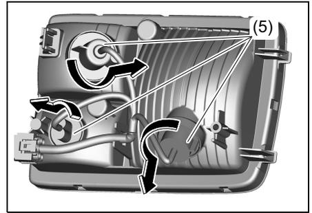
**4** 電球は図のように抜き差しします。
