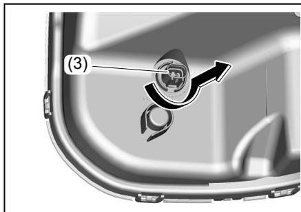
4 電球は図のように抜き差しします。
