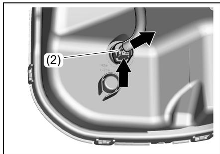
3 電球ソケット (3) は、反時計方向にまわして外します。
