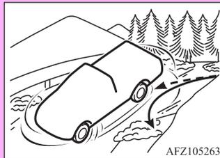
また、左右のタイヤの接地する路面状況が異なる時(例:片側アスファルト、他方氷上など)にエンジンプレーキをかけたり、加速すると車両の向きが急に変わることがあります。
