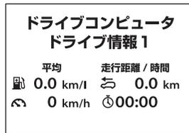
リセットしてから現在までの平均燃費、平均車速、走行距離（トリップメーター）および走行時間を表示します。
