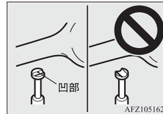
9. ジャッキ先端の凹部が指定箇所に当たっていることを確認してから、ジャッキハンドルを上下に動かして、タイヤが地面から少し浮かすまで静かにジャッキアップします。
