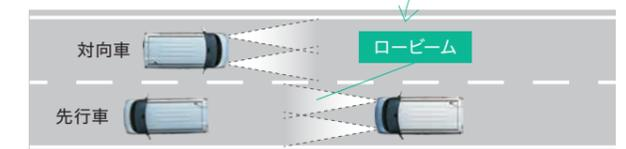
●約25km/h以上で作動します。●道路状況および天候状態などによっては、作動しない場合がありますので必要に応じて手動で切り替えてください。
