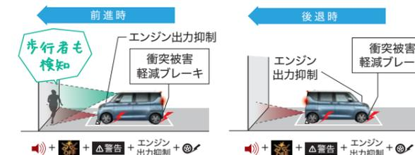
●エンジン出力抑制は、約6秒間作動します。前進時、車両、歩行者に対しては、停車状態～約25km/hの範囲で作動します。前進時、後退時とも、壁などの障害物に対しては、停車状態～約15km/hの範囲で作動します。●エンジン出力抑制に加え、ブレーキ制御が車速約2～15km/hの範囲で作動します。●車速約10km/h以下で障害物に近づく、警報ブザーとインフォメーション画面表示でお知らせします。●ハンドル操作やブレーキ操作による回避行動を行っているときは、作動しないまたは作動が遅れる場合があります。
