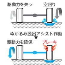
荒れた道などで駆動輪の左右どちらかが空回りした場合、空回りする方にブレーキをかけることで、もう一方に駆動力を伝達。荒れた道などからの脱出に効果を発揮します。
