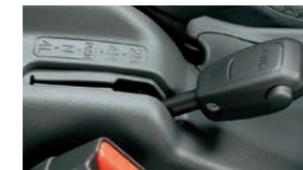
通常は2WDで走行。砂利道やあぜ道などの平坦な悪路では4H(4WD 高速)で、山道などでは4L(4WD 低速)が力を発揮する、力強い4WDシステム。
