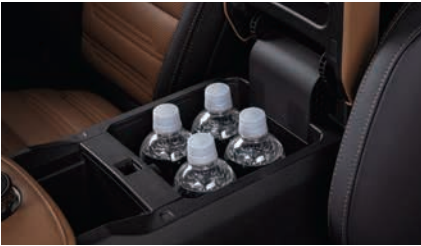
フロアコンソールボックス(アームレスト付) 600mlのペットボトル4本を収納可能。SUPER EXCEEDとEXCEEDには、保冷機能を装備しています。
