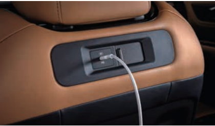
充電用USBポート Type-C×2(前席シートバック) 前席シートバックのスマートフォンポケットとの距離・角度まで配慮し、USBケーブルをスマートに取り回せる左右シートにレイアウトしています。
