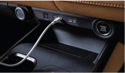
データ通信USBポート Type-C×2(フロントコンソール) ディスプレイオーディオとの接続や充電がしやすく、運転操作の邪魔にならないフロントコンソールにレイアウトしています。
