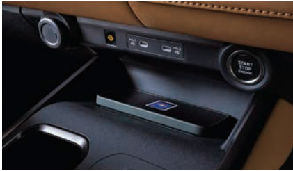
ワイヤレス充電器(フロントコンソール) 【標準装備】 SUPER EXCEED、EXCEED フロントコンソールトレイには、Qi対応スマートフォンを置くだけで充電できるワイヤレス充電器を設定しました。 ■「Qi」およびQiシンボルはワイヤレスパワーコンソーシアム(WPC)の商標または登録商標です。
