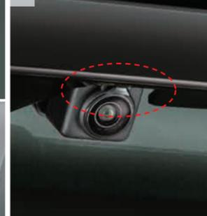
リヤカメラに付着した雨滴などを高圧空気で飛ばし、後方画像が見えにくくなるのを抑制します。
