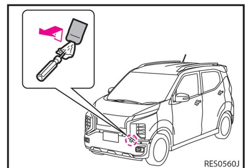
3. 金属の固い棒などを使用して、けん引フックを取り付ける。
